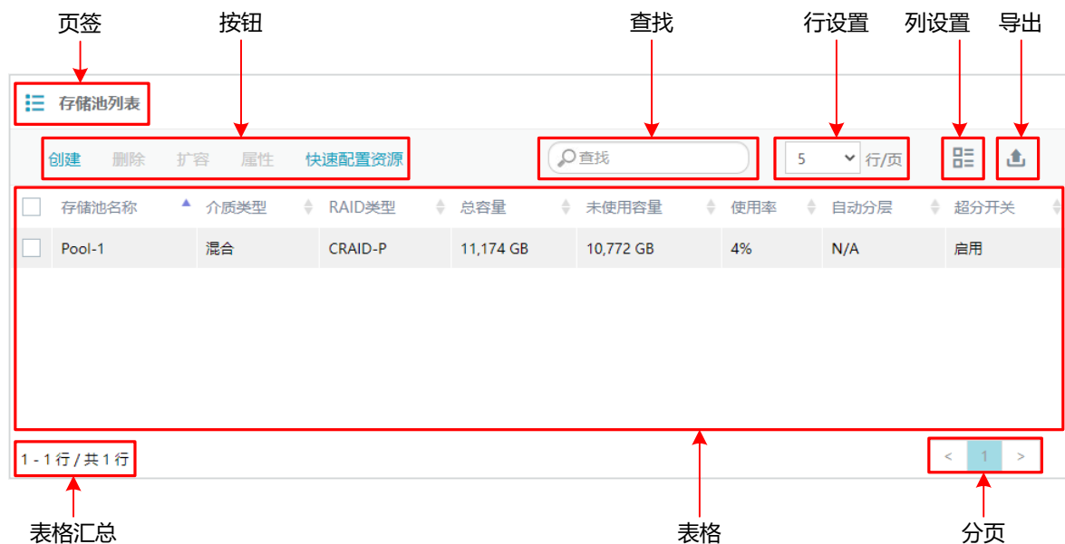
图3-9 ODSP Scope+信息显示区示例
